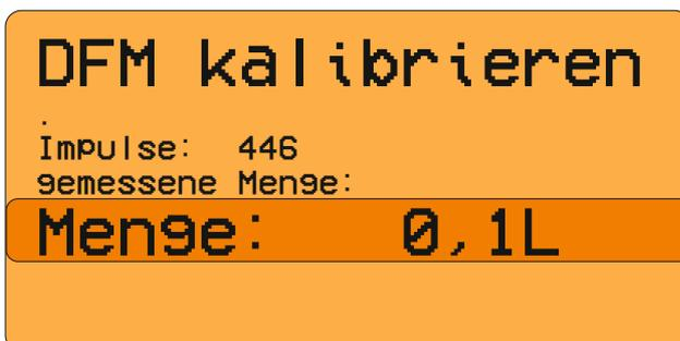
Für das berechnen des Kalibrierwertes muß die dosierte Menge aus dem Meßbecher ermittelt und eingegeben werden.
